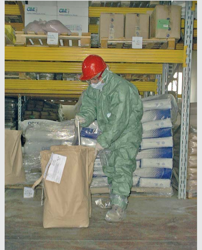
Esempio di vestiario e dispositivi di protezione individuale, mentre un operatore esegue un prelievo da sacco sigillato mediante Sonda a lungo setto a partizioni (tipo Nobbe).
