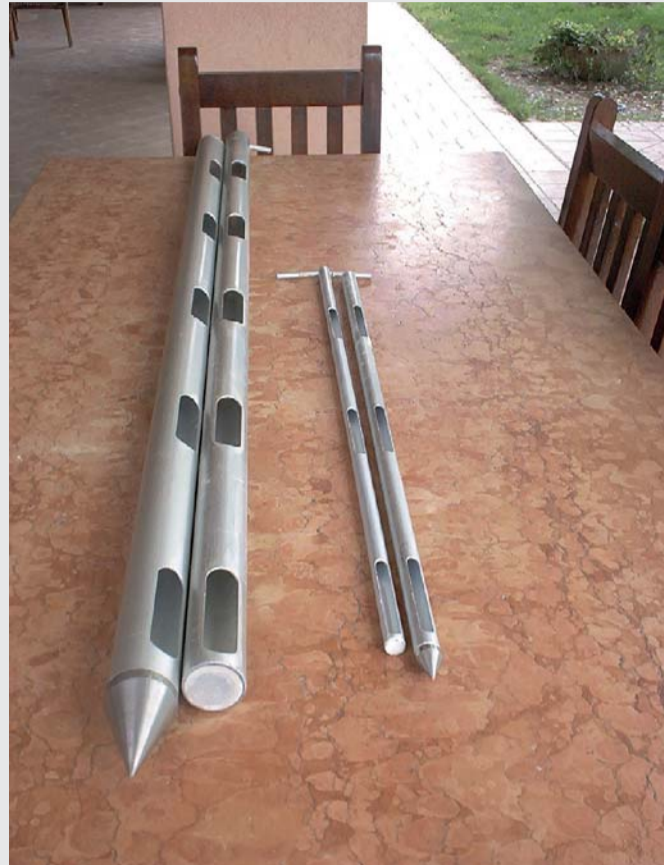
Sonda a lungo setto e a partizioni (tipo Nobbe).
